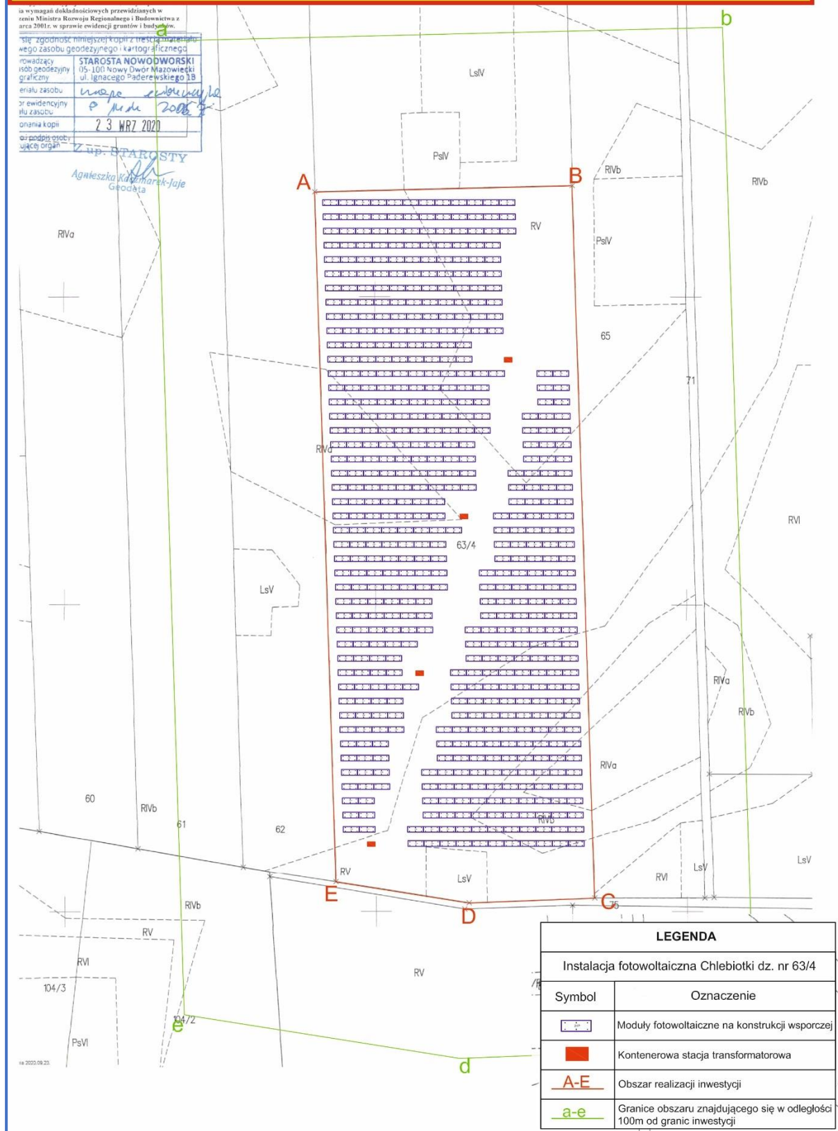
Rys. 4 Instalacja fotowoltaiczna – plan sytuacyjny.
